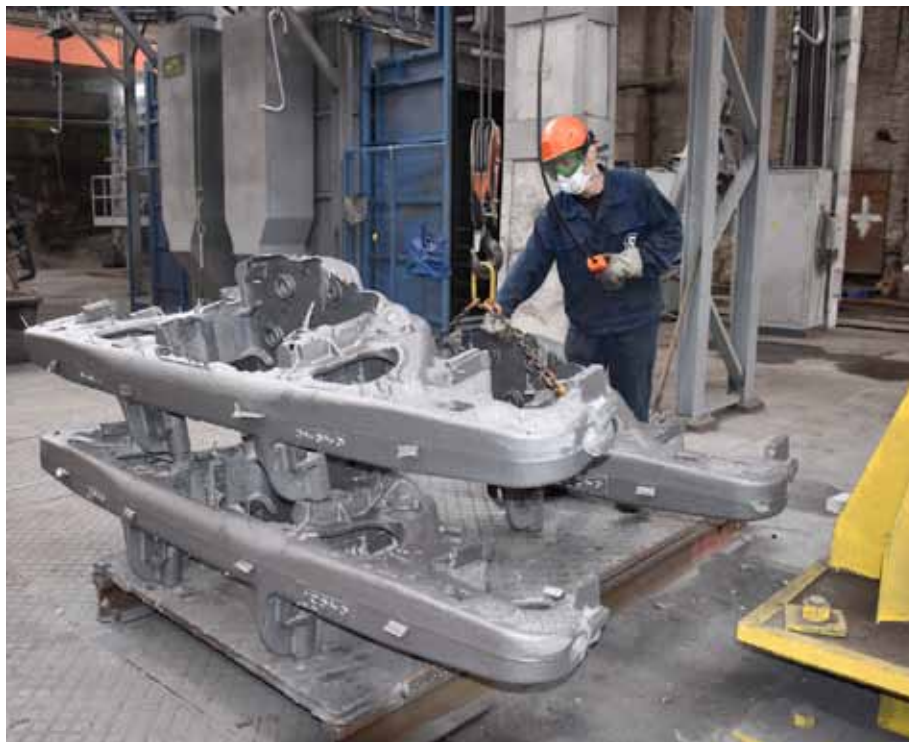
Рис. 1. Рамы боковые, отлитые на АО «ПО «Бежицкая сталь»» (клеймо 12)
