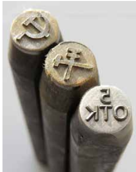
Рис. 2. Клейма инспекторские и отдела технического контроля
