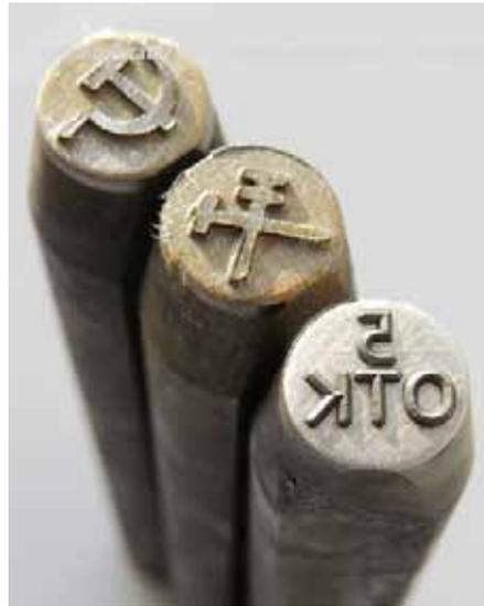
Рис. 2. Клейма инспекторские и отдела технического контроля
