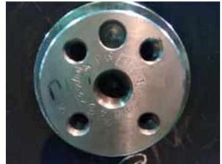
Рис. 2. Клейма инспекторские и отдела технического контроля
